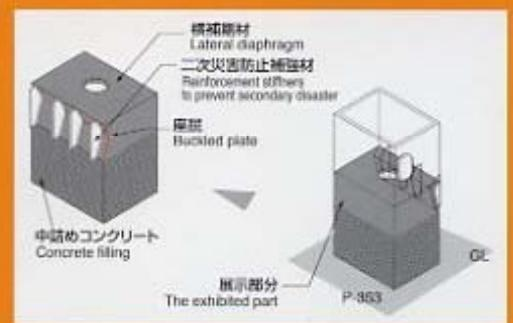
■損傷内容／橋脚基部の中詰めコンクリートと直上の横補剛材間で板パネルの局部座屈が発生し、梁の張り出しが大きい海側に大きく傾斜した
