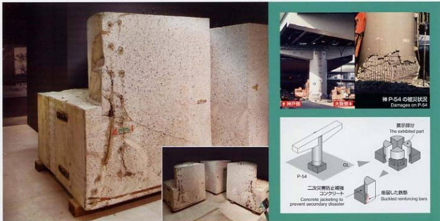
■損傷内容／柱基部付近において、主鉄筋が全周にわたって座屈し、帶鉄筋がばらける激しい曲げせん断損傷が生じた
