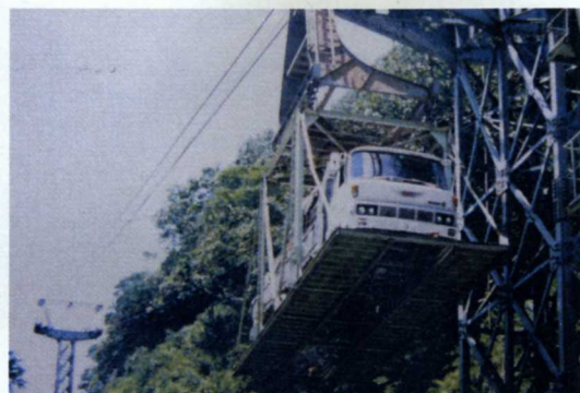
写真-10 荷物を積んだトラックごと運ぶロープウェイ
